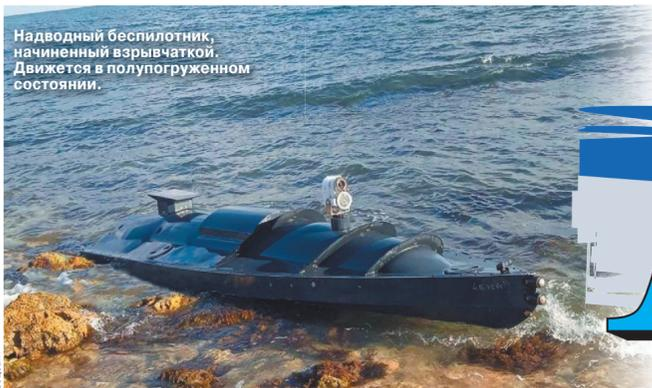
Надводный беспилотник, начиненный взрывчаткой. Двигается в полупогруженном состоянии.
