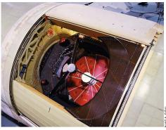
Исследовательский самолет с телескопом «София» на борту; открытый люк в хвостовом отсеке (справа)
