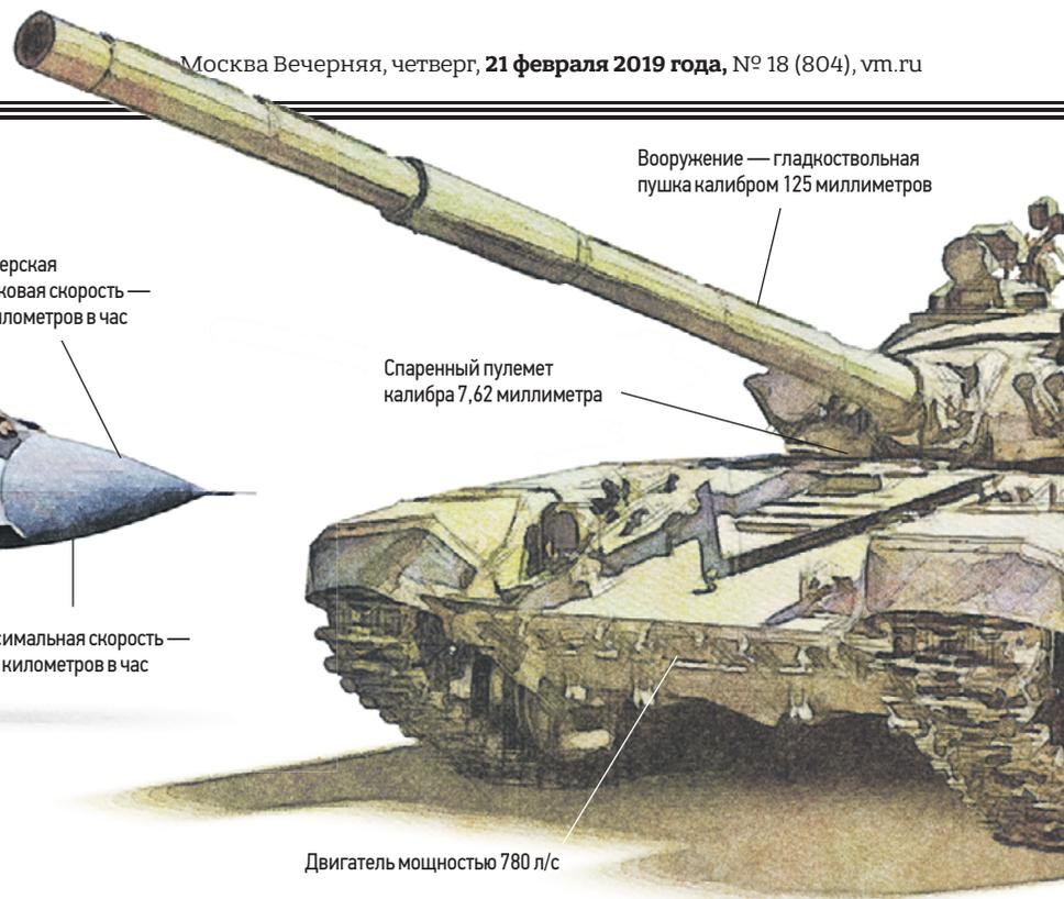
Вооружение — гладкоствольная пушка калибром 125 миллиметров
